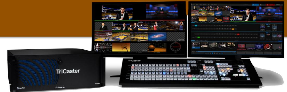
**Control maestro** para el proceso y grabación de video. Debe incluir mezclador de video, sistemas de grabación en disco duro, monitores de video para cada cámara, así como para la mezcla (program) y para la grabación (REC).
